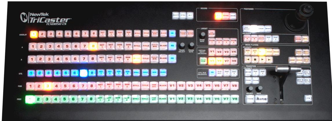
TriCaster TCXD850 CSは、TriCaster TCXD850の機能と、操作し易いユーザーインターフェースをハードウェアとして構成したもので、ボタンやTバー、回転ツマミ、ジョイスティックを装備し、オペレーターがライブでのスイッチング操作をスムーズに行えるようにしたものです。
